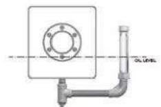
Montato su un'apertura di scarico dell'olio.
